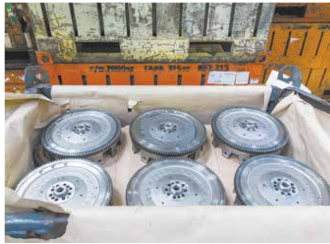
Маховики, изготовленные на заводе двигателей, в АЗК поступают на участок консервации
