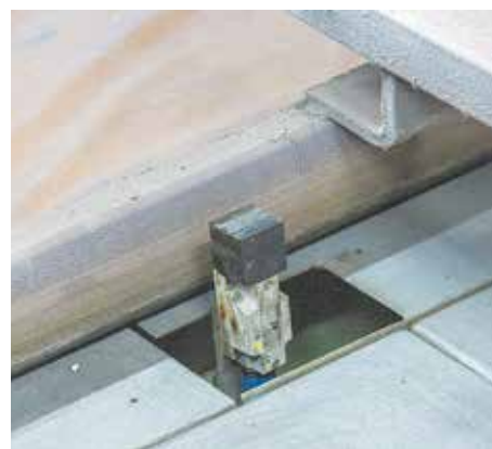
Миниатюрный датчик считывает со склада тип каркаса кабины
