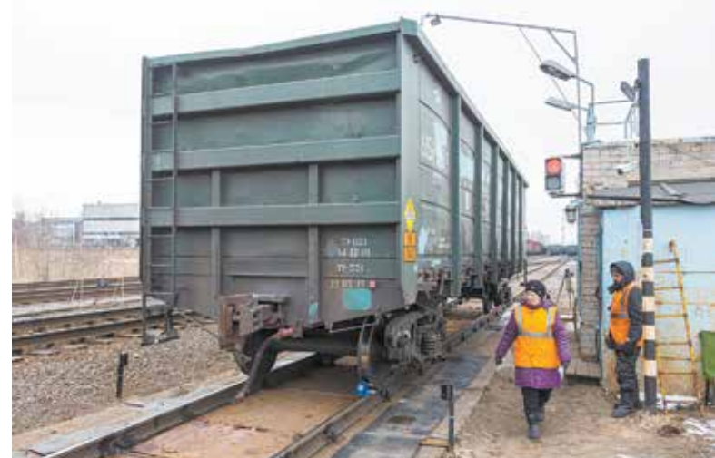
Вагон стоит на весах, видеокamera сверху передаёт изображение груза на монитор в диспетчерской. Новый светофор скоро подаст зелёный сигнал, разрешающий продолжить движение
