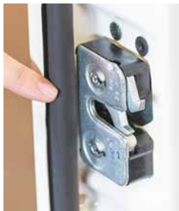
Заменив крестообразный шлиц винта на шестигранный, удалось усилить крепление дверной ручки и замка
