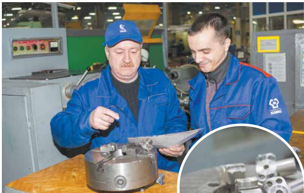
Айнур Мирсаетов (на фото справа): «Совместно с токарем Газинуром Манеровым (на фото слева) и конструктором Ольгой Сергачёвой мы разработали для патрона конструкцию универсальных кулачков. Теперь можно выполнить обе операции, не переустанавливая патрон и не перемещая детали»
