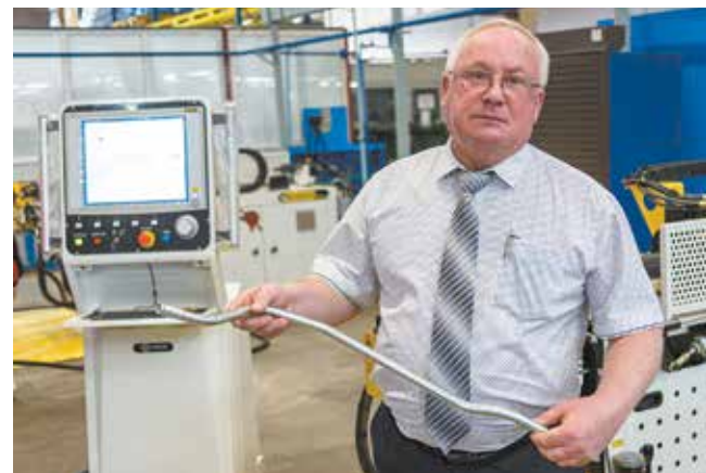
По словам Константина Климкина, станки старого образца иногда давали гофры в местах сгиба. С автоматикой об этом дефекте забыли. Новый станок «чувствует» сопротивление металла и немного снижает давление в момент сгиба. «Трубка получается эталонной», — доволен начальник цеха
