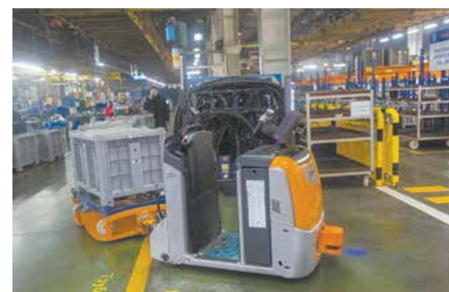
На поворотах в целях безопасности беспилотник замедляет ход и подаёт звуковой сигнал
