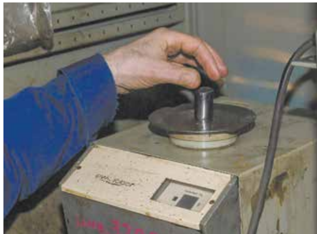
Цикл изготовления в ЦХВ начинается с дозированной отрезки заготовок. Масса изделия контролируется на электронных весах
