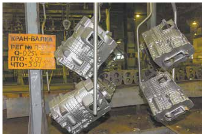
После стального душа детали чистые и подготовленные к окраске
