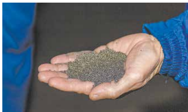
Стальная дробь используется для очистки отливок, прошедших термообработку
