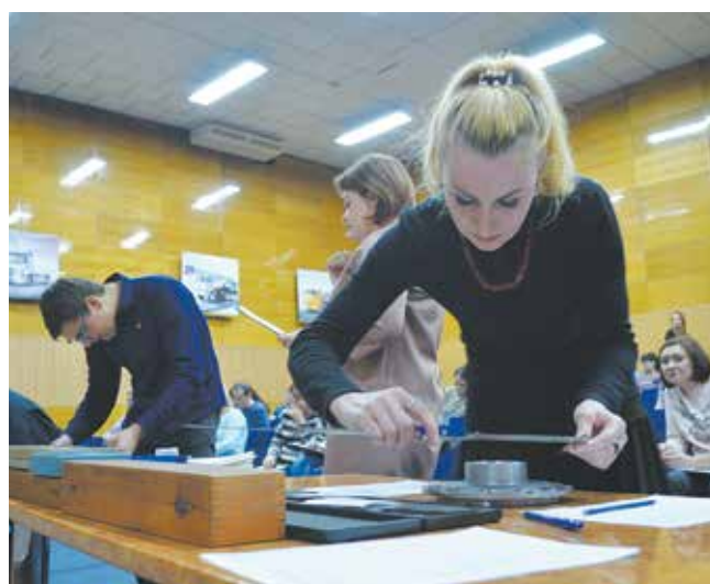
Контролёры ОТК делают замеры ступицы шестерни на предмет её соответствия чертежам
