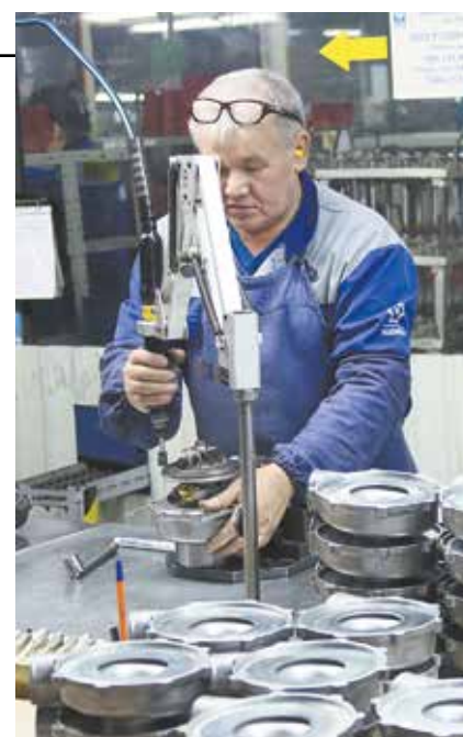
После появления пневматических гайковёртов производительность труда на участке увеличилась в 1,5 раза
