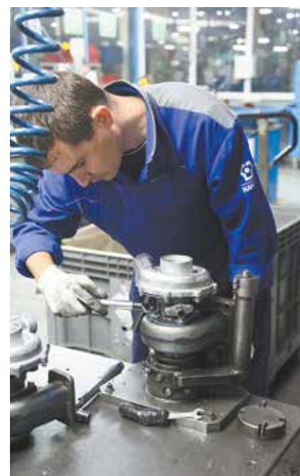
Балансировка ротора — важный этап сборки. От качества её проведения зависит срок службы турбокомпрессора
