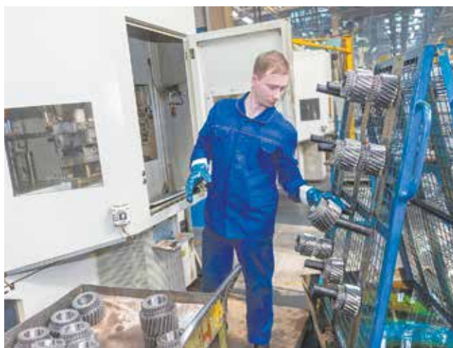
Не по одной, а сразу 20 деталей будет загружать оператор, когда у станка появится автоматическая линия
