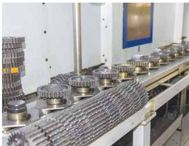
Не по одной, а сразу 20 деталей будет загружать оператор, когда у станка появится автоматическая линия
