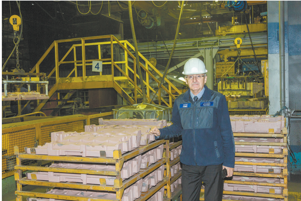
Формовочная линия ХВС-1 — один из участков, на котором делается акцент при модернизации ПЧЛ. Именно здесь изготавливаются наиболее сложные отливки, в частности, «блок цилиндров» для СП «КАММИНЗ КАМА». Реализуя проект по импортозамещению, литейщики продолжают работать над качеством отливки
