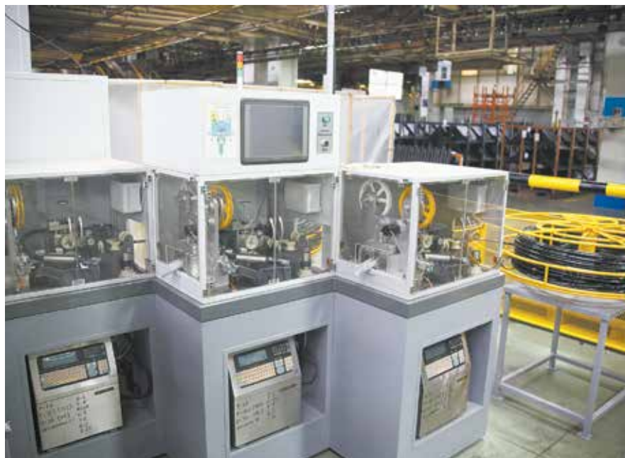
Эта новая установка на участке сборки полиамидных трубок значительно облегчит труд слесарей и комплектовщиц. В бухты аппарата закладываются все виды трубок, подаётся команда — и он сам протягивает и отрезает изделие нужной длины, а затем маркирует его. Раньше всё это делалось вручную
