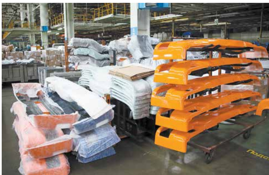
В зоне подсортировки нижнего пояса бамперы готовят под закладку плана сборки автомобилей
