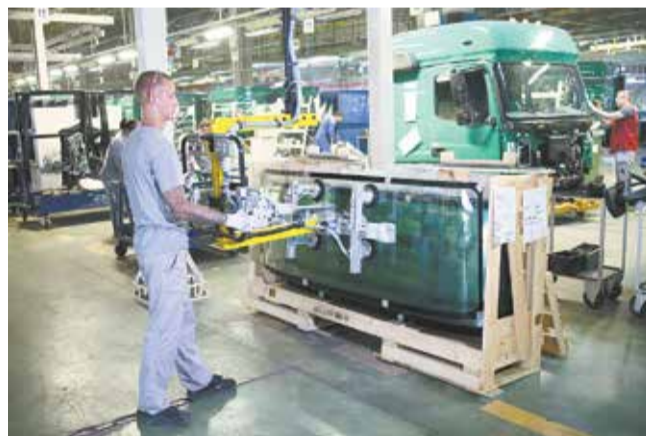
Новый манипулятор легко и бережно поднимает тяжёлые лобовые стёкла
