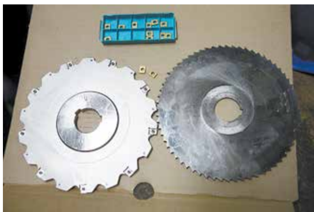
Классические фрезы (справа) уступают место прогрессивному инструменту
