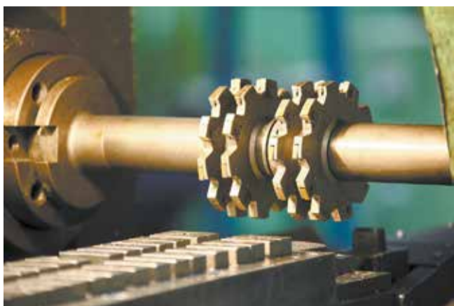
Специальные пластины повышают производительность и износостойкость фрез
