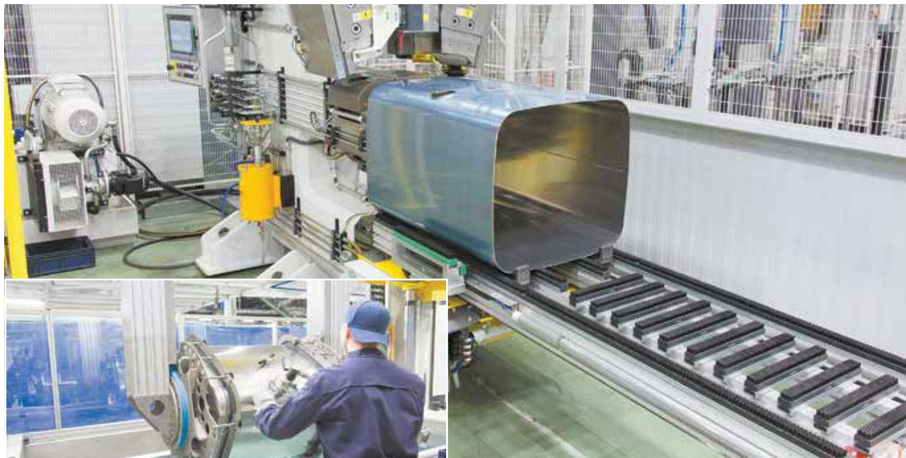
Всё начинается с подъёма механической рукой листа алюминия и его сгиба, и доходит до финишного этапа — испытаний на герметичность уже сваренного бака. Каждого
