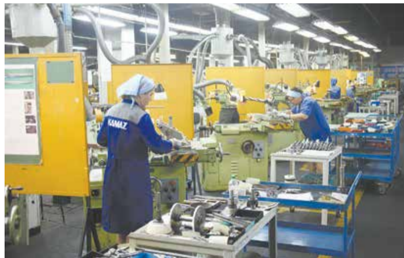
Пылеуловители есть на каждом рабочем месте заточницы, а вот эффективность их работы зависит от мощности ротоклона
