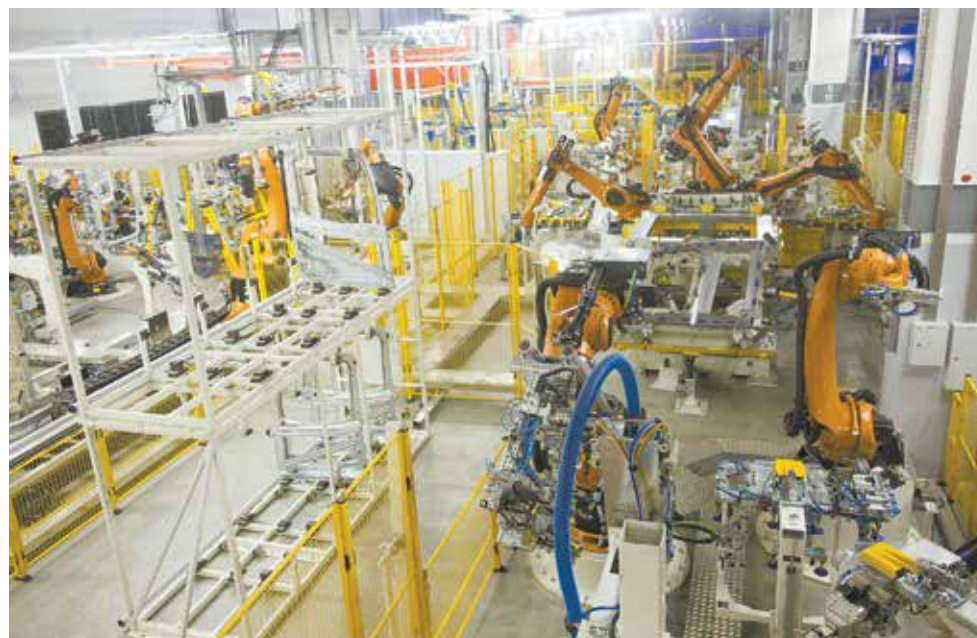
Роботы собирают и варят каркас кабины...
