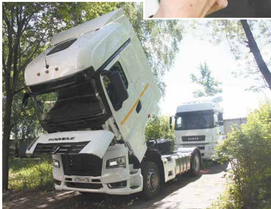
Один из технических нюансов — новое расположение кнопки подъёма кабины. Для её извлечения нужно сначала поднять капот большегруза
