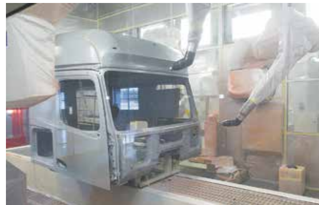
Роботы собирают и варят каркас кабины...
