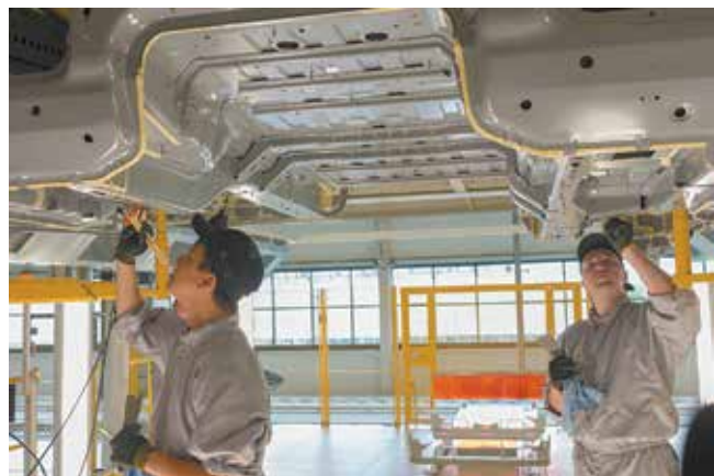
На заводе есть несколько позиций, где без ручного труда не обойтись. Одна из них — нанесение герметика для защиты от коррозии
