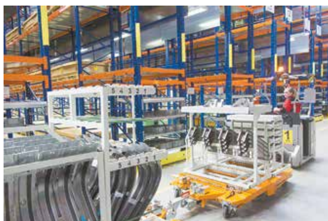
Завод начинается с зоны логистики. Детали укладываются на тележку в строгой очередности
