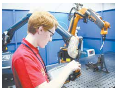
Студент Техколледжа Дамир Мофаздалов написал программу для комплекса по роботизированной сварке
