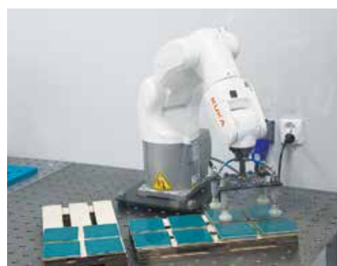
Промышленный робот малой грузоподъёмности KUKA имитирует задачу палетирования
