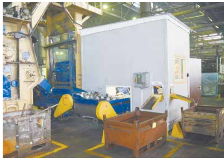
... а брак по специальному склизу скатывается в соответствующую тару
