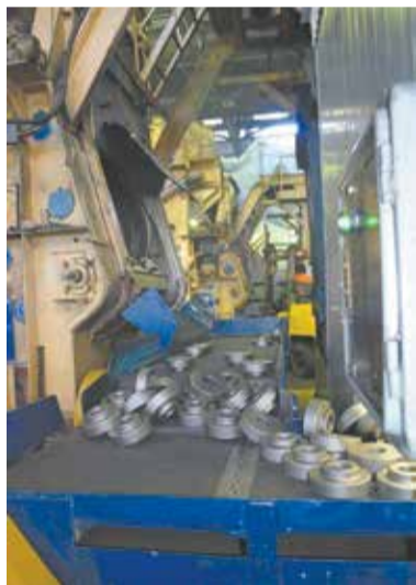
Покówki после дробеочистки поступают к контролёрам...
