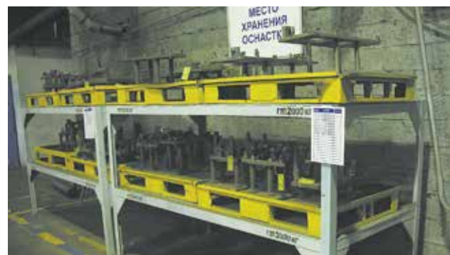
Одно из улучшений появилось благодаря идее наладчика станков и манипуляторов с программным управлением Инсафа Сулейманова. Он предложил установить два двухъярусных стеллажа для хранения оснастки. Раньше оснастка лежала на полу, на поиски нужной детали тратилось время. Теперь на полках царит порядок, а таблички со списком оснастки и номером соответствующей ячейки помогают найти нужную вещь за считанные секунды
