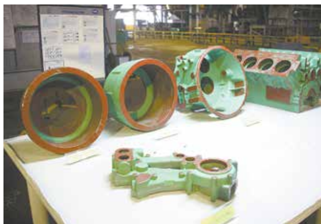
Из нововведений на участке — стол с визуализацией несоответствий: красным цветом на отливках отмечаются зоны, наиболее подверженные дефектам, зелёным — те, которые не подлежат обработке
