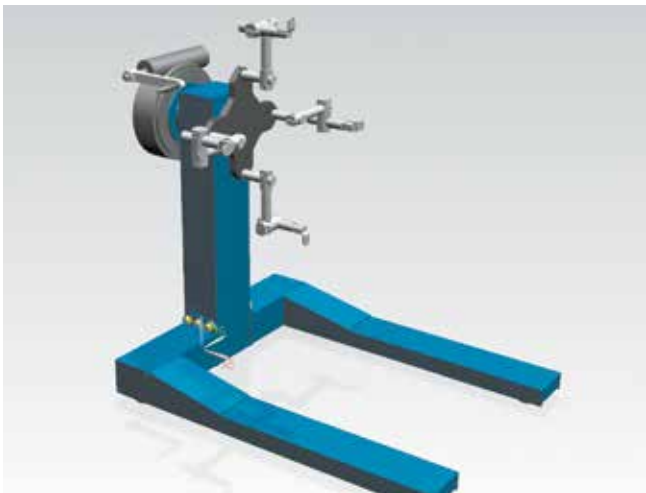
Стенд-кантователь для сборки коробки передач создан для проведения симуляций в Tecnomatix
