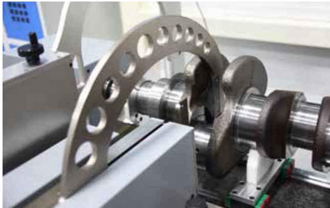
По словам Александра Полушкина, на новом автоматическом оборудовании проверка геометрии коленвала занимает считанные минуты
