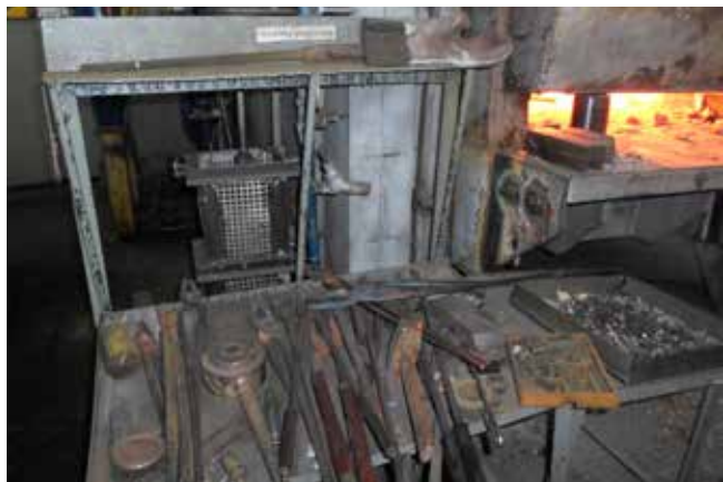
В арсенале кузнеца свободнойковки — газовая печь, где прутки-заготовки разогреваются до 1000-1200 градусов, полутоннальный молот и молотки, сварочный аппарат, кузнечные топоры, кочерга, оснастка самых разных видов, разнообразные клещи... Многие он и сам изготовил для себя — вдобавок к наследству предшественников
