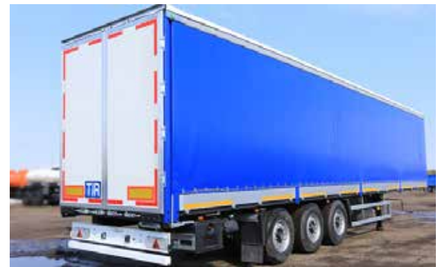
Поскольку в задней части установлены распашные двери, полуприцеп становится универсальным средством перевозки: его можно загружать сзади, сбоку и сверху — при помощи крана или погрузчика, который может заехать прямо внутрь.
