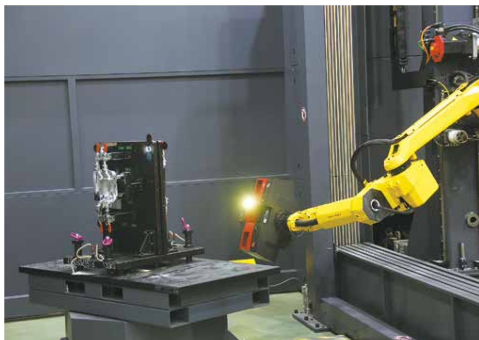
Съёмка ведётся в автоматическом режиме, а программу движения камеры составляют операторы
