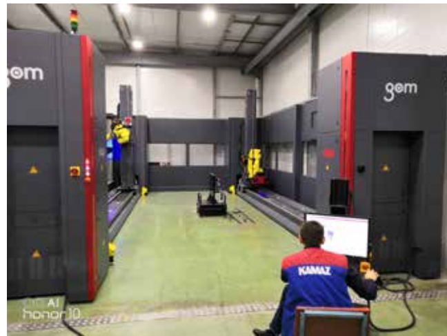
Конструкция деталей усложняется, мерить их универсальным способом невозможно. Новая оптическая измерительная машина, со своей стороны, тоже работает на качество
