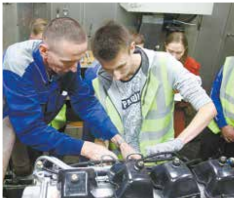
Алексей Комаров регулирует клапаны двигателя под руководством испытателя с 30-летним стажем Рафака Якупова
