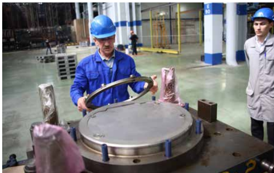
Стопорное кольцо уберёжёт руки штамповщиц и облегчит им работу
