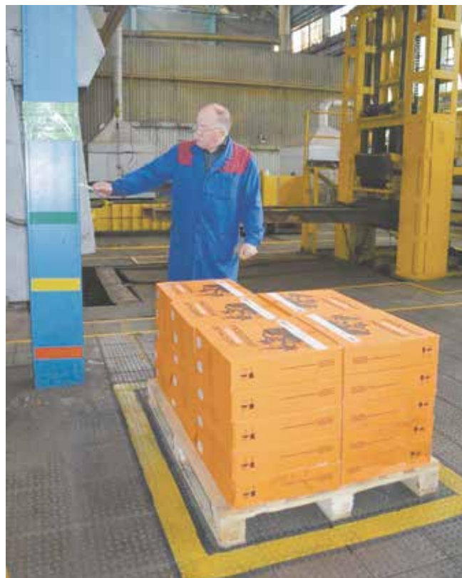
Слесарь-ремонтник Михаил Бурчик представляет нам появившийся на участке супермаркет. Сюда от поставщика прибывает порошковая наплавочная проволока, а «светофорные» метки сигнализируют мастеру, когда лимит к концу, и нужно пополнить запасы
