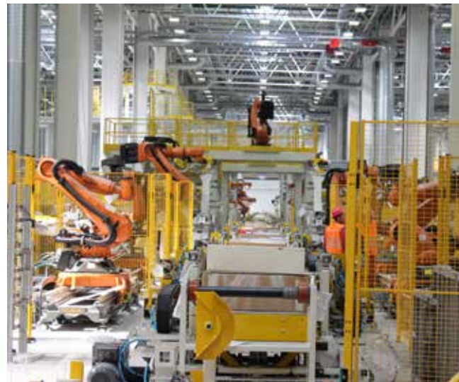
Роботы станут главными действующими лицами на главной линии сварки каркаса кабины
