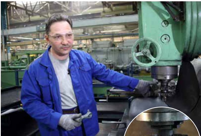
Рацпредложение Ильи Фролова: обработка рычага сразу двумя фрезами помогла сэкономить на каждой детали целую минуту
