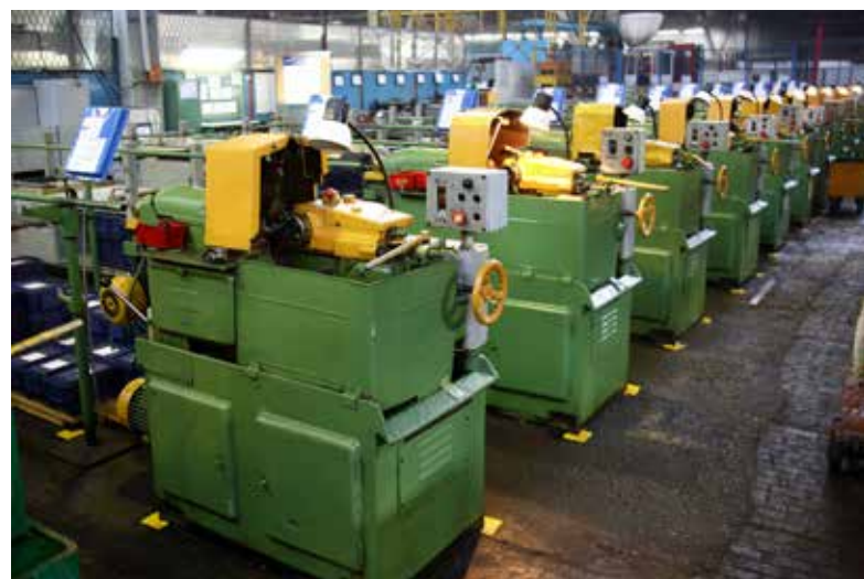
На эталонном участке каждый оператор обслуживает от четырёх до восьми станков
