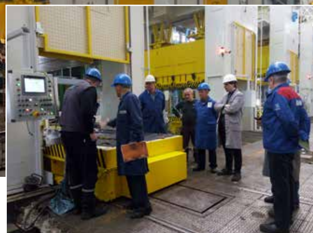
Идёт пусконаладка одного из пяти прессов модернизированной линии с автоматической системой управления на базе контроллеров Siemens. На это оборудование возможна установка MES-системы. Передавая руководителям данные в режиме онлайн, она позволит значительно повысить качество управления производством
