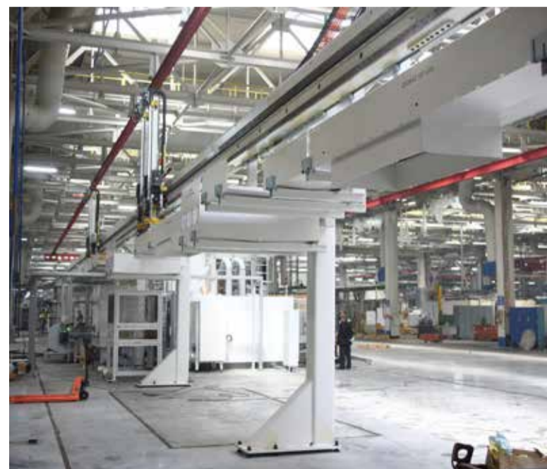
В цехе уже смонтирован центральный портал, по которому заготовки коленвалов будут передвигаться от одной операции к другой. Всего здесь поставят 16 видов оборудования
