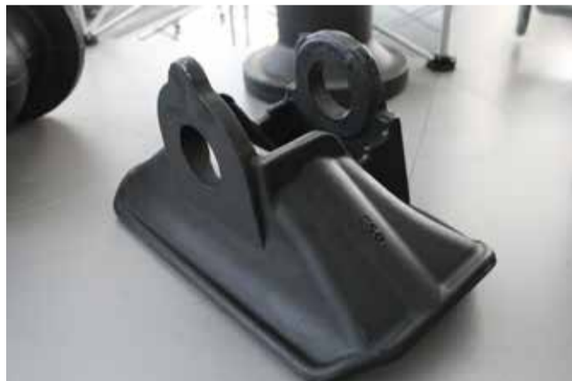
Отливка под названием «Головка колокола» из первого пакета заготовок уже отлично зарекомендовала себя
