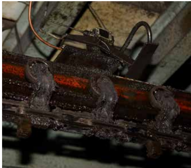
Срабатывающий датчик позволяет подавать смазку в нужном количестве с двух сторон
