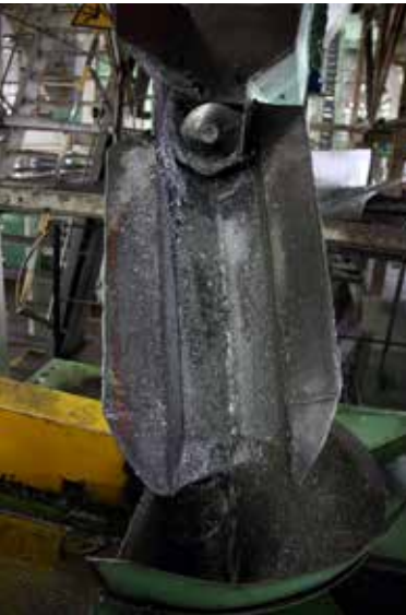
Число оборотов шнека в минуту уменьшили с 18 до 12 с помощью изготовления цепной передачи (ранее привод на шнеке был прямой с мотор-редуктора)
