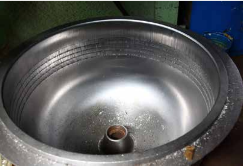
За десятилетия работы в барабанах образовались глубокие канавки
