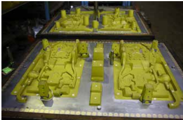
На этот раз победу в конкурсе Ухов принесло изменение конструкции литниковой системы для отливки «кронштейна» на тяжёлые автомобили нового модельного ряда. Уже за полгода после внедрения экономический эффект — свыше 10 млн рублей
