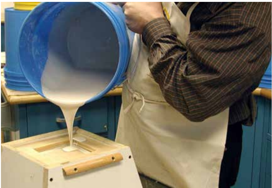
Компаунд — полимерная композиция для заливки деталей, изолирующая токопроводящие схемы. Используется в качестве электроизоляционного материала и композиции для заполнения различных ёмкостей и технологических объёмов
