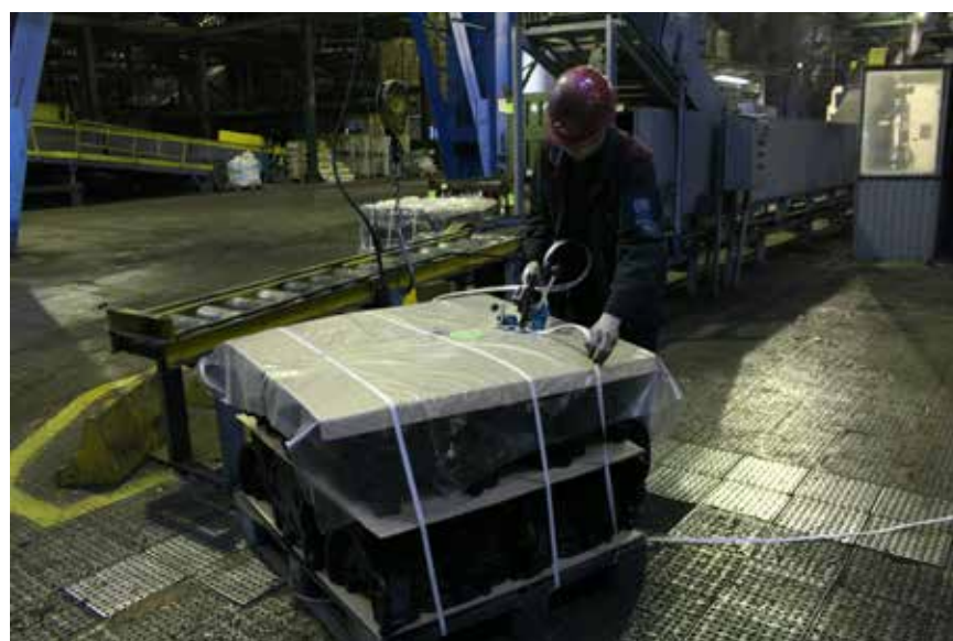
В упаковке получит отливки для головки блока цилиндров Заволжский моторный завод — один из постоянных заказчиков литейного. Процесс упаковки идёт в ЛЦ-4 производства чугунного литья
