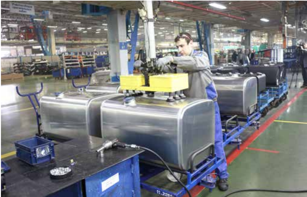
КАМАЗы нового модельного ряда уже комплектуются высококачественными алюминиевыми топливными баками
