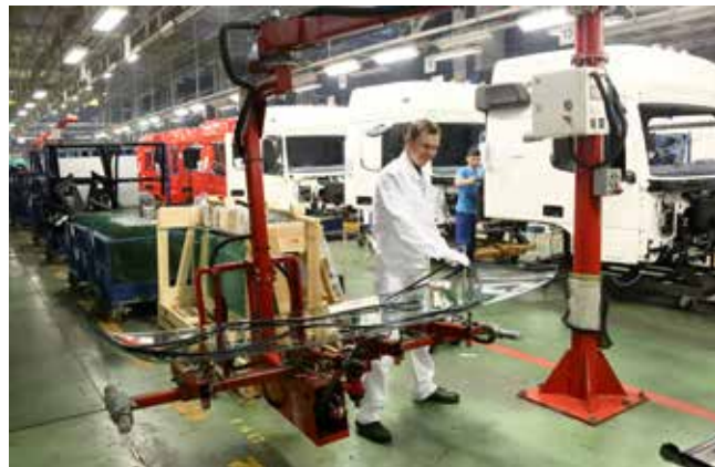
Манипулятор для установки лобового стекла должен быть модернизирован, а на следующем этапе развития его заменит робот
