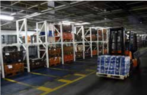
В супермаркете эталонного участка очереди на покраску ждёт трёхдневный запас заготовок
