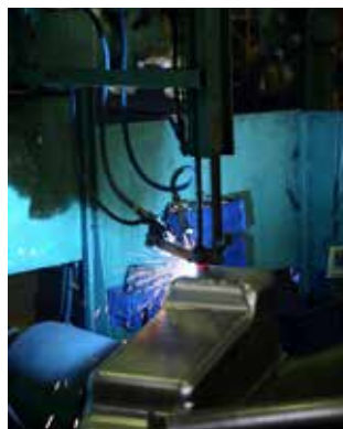
Мастера предлагают при приваривании сливной бобышки заменить дуговую сварку на контактную
