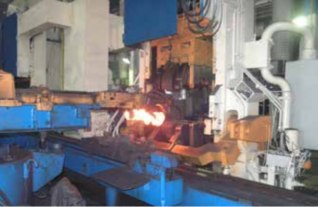
Линия коленчатого вала, её огромный пресс и ковальная часть с муфтой-тормозом в КПК-3 — один из главных объектов ремонта
