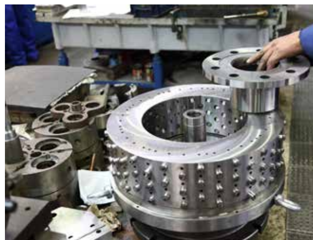
Для изготовления этого зажимного патрона зубообрабатывающего станка инструментальщикам даже пришлось привлечь помощь партнёров с ПРЗ. Но сами кулачки для обеспечения равномерного зажима обода зубчатого маховика ризовцы дорабатывали и шлифовали сами. На оборудовании завода двигателей благодаря этому «ёжику» обрабатываются одновременно сразу шесть ободов зубчатого маховика
