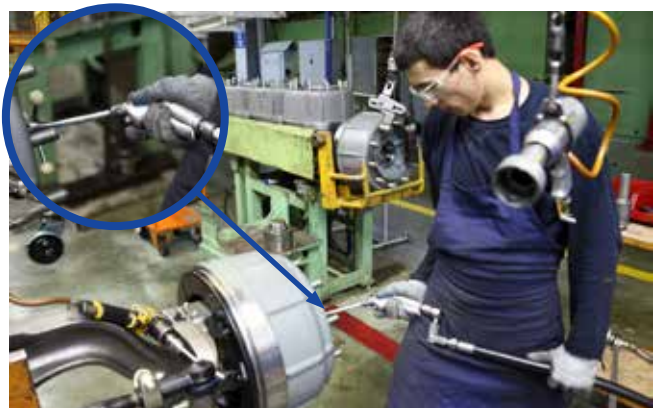
Смазка на подшипниковый узел теперь наносится не кисточкой, а специальным пистолетом
