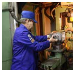
Отливка помещается в рентген-камеру. После сканирования на новенькие мониторы поступает качественное цифровое изображение
