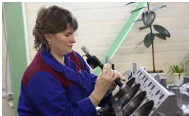
В зале замеров контролёры проверяют блоки на качество. Например, на стабильность диаметров, которые должны быть в одном диапазоне
