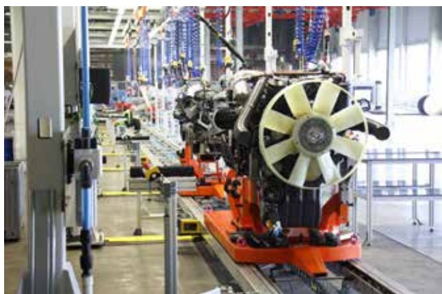
Мощность новой линии — 12 тыс. моторов в год
