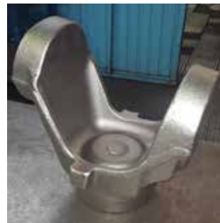
Сложность поковки в том, что она несимметричная и очень габаритная
