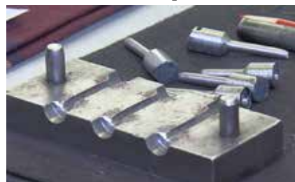
Проба-трэф, из которой вытачивали контрольный образец, под конец проверки выглядит так — разорванной пополам
