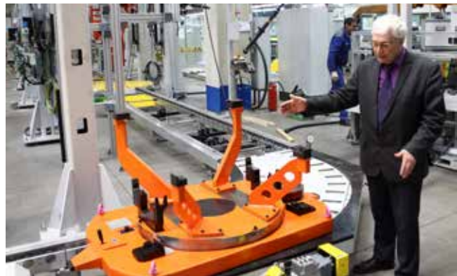
Владимир Баринов: «На этой неделе планируется пробное перемещение спутника с двигателем по конвейеру. Так мы проверим правильность сборки транспортной системы конвейера»
