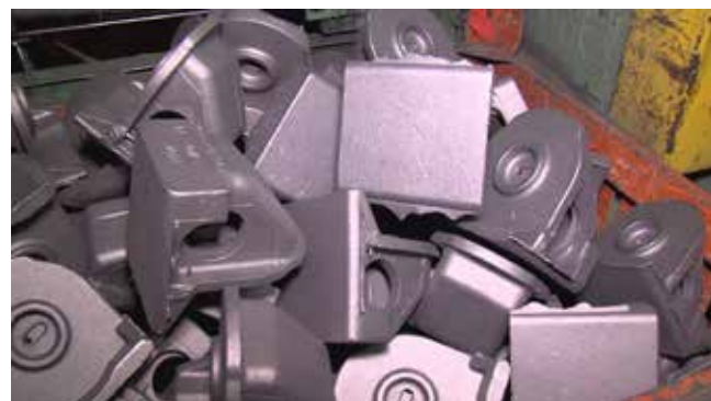
Крестовина — еще одна отливка для РЖД, которая уже поставлена на серийный поток
