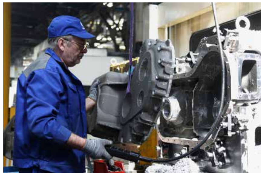
Наладчик станков с ПУ Николай Софронов производит сборку для совместной обработки картера раздаточной коробки
