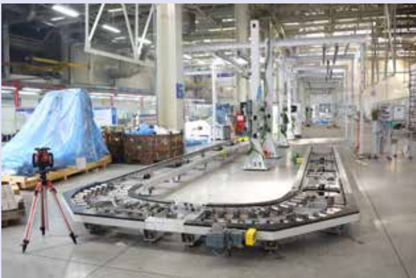
На новом сборочном конвейере завода двигателей в рамках проекта «Тибет» приступили к установке транспортной системы, состоящей из рольгангов.
