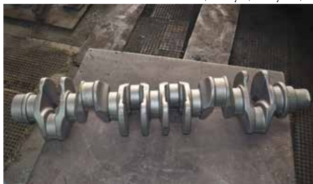
Теперь поковка готова к отправке на завод двигателей, чтобы стать частью нового нашего мотора — Р6
