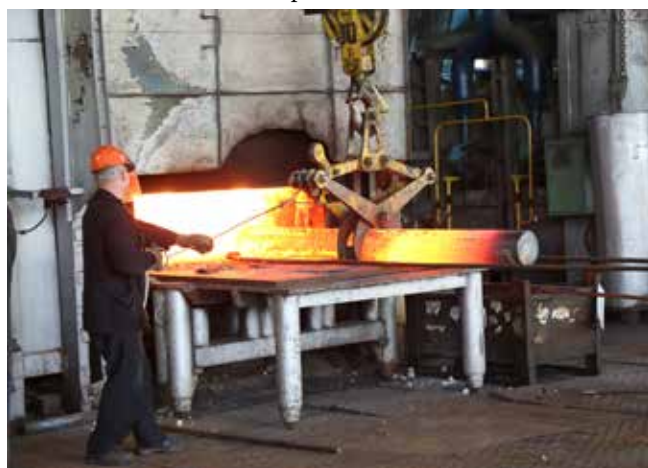
В родном корпусе РИЗа оборудован и термический участок, где ведётся отжиг поковок до 1000 кг
