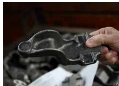
Заготовки для кареток ПТК изготавливаются тоже в ремонтно-кузнечном корпусе
