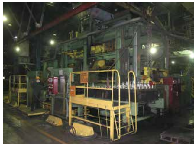
Формовочная линия ХВС-1 в ПЧЛ — один из участков, где введены должности освобождённых бригадиров. Благодаря Альфиру Иксанову и Андрею Зубареву, предложившим доработать оснастку, изменив знаки под стержни, и ввести противоотжимные пояски на отливку, здесь смогли на 25% снизить брак по отливке «водило»
