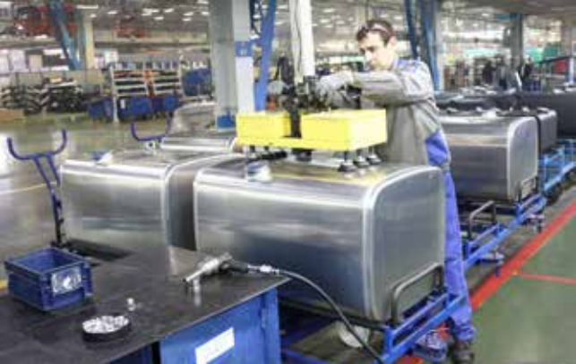
Бак подцепляется с помощью автомата-присоски
