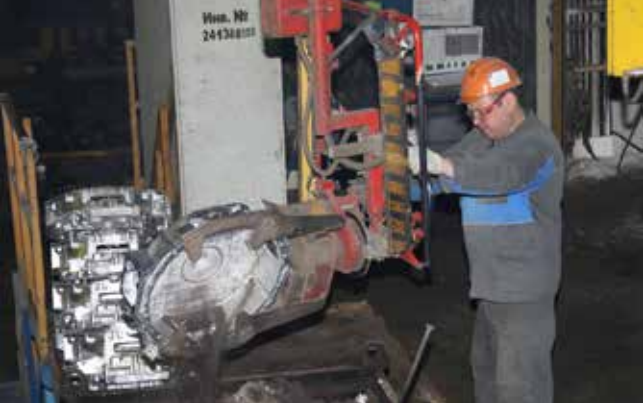
На участке заливки отливок под низким давлением рождается алюминиевый картер маховика
