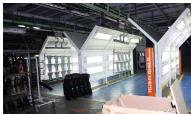
Сразу за камерой — ворота качества. На ГСК отправятся только хорошо покрашенные детали
