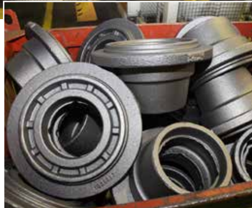
Теперь отливки ступиц заднего моста обрабатываются на автоматизированном станке MAUS
