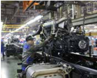
Установка двигателя на раму теперь минутное дело
