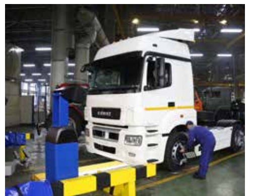
Принцип работы нового стенда АвЗ проверки развала-схождения базируется на основе 3D-технологий
